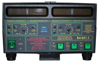
Питание блока управления намагничиванием осуществляется от сети переменного тока напряжением 220~B, частотой  $50~\Gamma$ ц. Мощность, потребляемая от сети переменного тока, не более 2000~BA.
