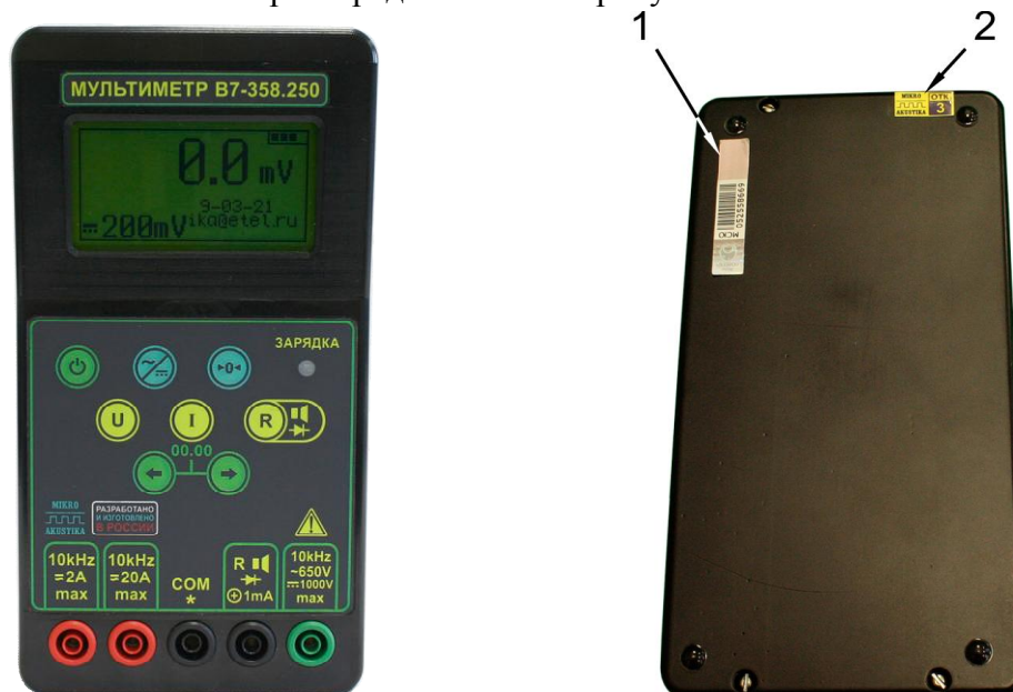
Рисунок 1 - Общий вид и схема пломбировки мультиметров
